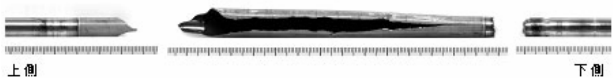
図 4-2 NSRR 実験で破損した燃料棒 (ZIRLO 被覆 PWR-UO 2 燃料, 燃焼度: 79 GWd/t)
